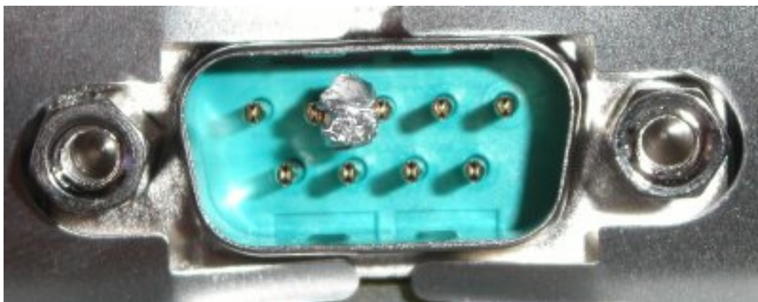
Konektor RS-232 s propojeným 2. a 3. pinem
